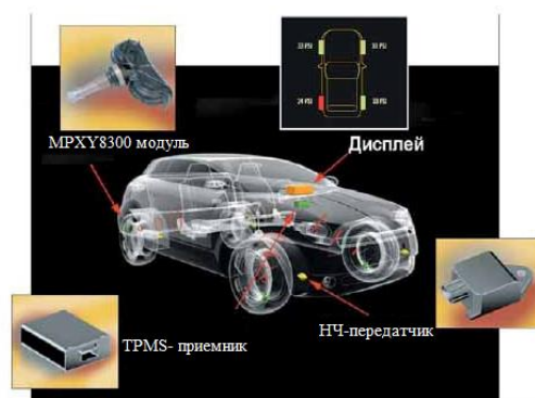
Рис. 2.1. Архитектура TPMS системы с методом прямого контроля давления в шинах и пример колесного модуля MPXU8300 от Freescale Semiconductor
