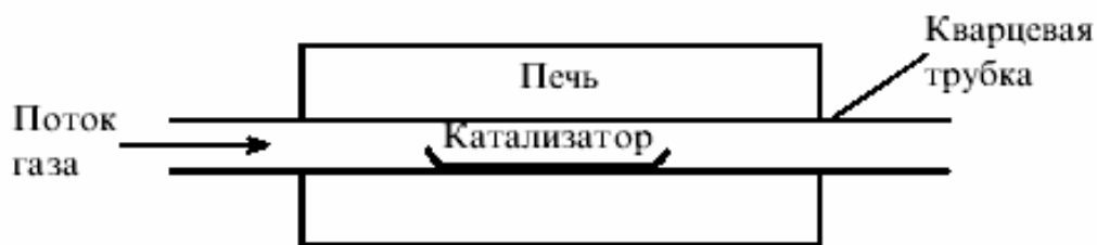
Рис. 2. Установка для получения углеродных нанотрубок методом CVD.
