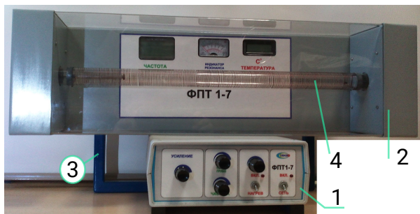
Рис. 7.2. Общий вид экспериментальной установки ФПТ 1-7: 1 – блок приборов; 2 – блок рабочего элемента; 3 – стойка; 4 – труба с нагретателем. (термопара)
