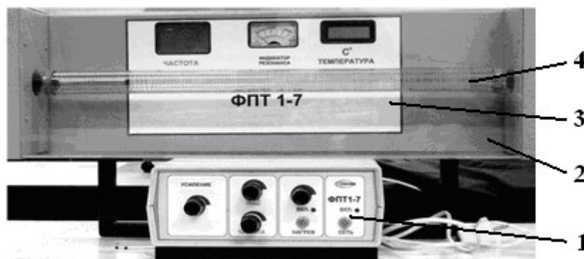
Рис. 2. Общий вид экспериментальной установки ФПТ 1-7: 1 – блок приборов; 2 – блок рабочего элемента; 3 – стойка; 4 – труба с нагревателем.
